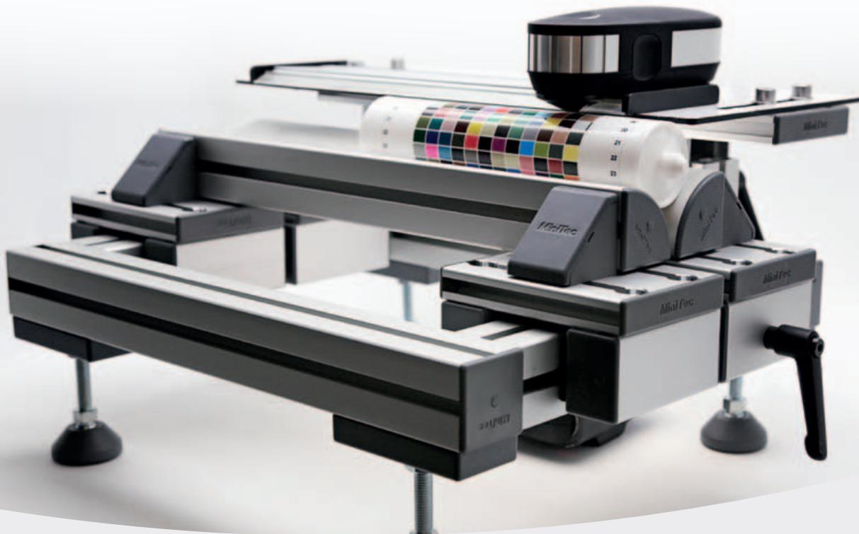
Der Measure Mount ist eine Vorrichtung zur Nutzung des Handmessgerät X-Rite i1Basic Pro 2 zur Farbmessung von zylindrischen Form- und Hohlkörpern wie Dosen, Flaschen, Tuben und Gläsern.
