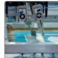
Der Siebdruck wird durch Rasterweiten von üblicherweise bis zu 33 L/cm (85 lpi) gekennzeichnet. Ferner werden zumeist Sonderfarben und eine große Bandbreite von Substraten verwendet.
